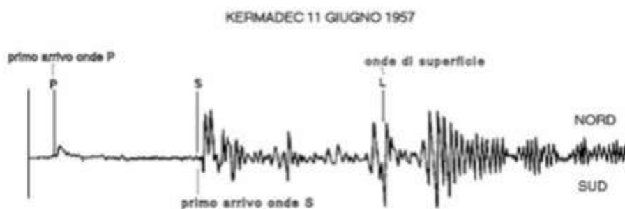
Fig.2 - Tipico sismogramma registrato in superficie a grande distanza
