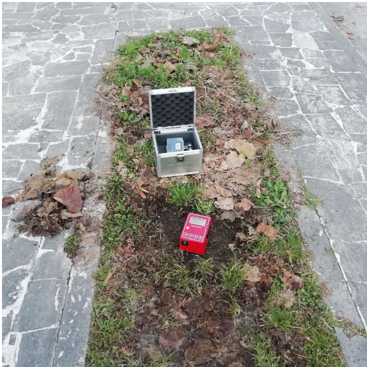
Foto 3:Foto tromografo in fase registrazione HVSR1.
